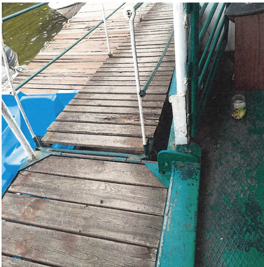
Fot. 23. Trap boczny, przyspawany na stałe do prawej burty pokładu dolnego.
