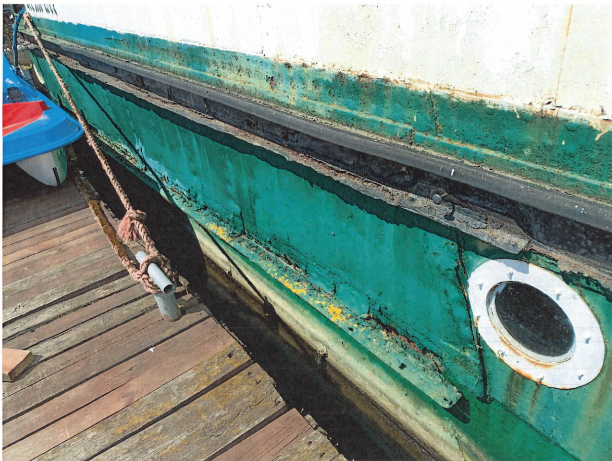
Fot. 26. Prawa burta, odstająca część maskująca, dospawana w miejscu usuniętego koła napędowego parowca.
