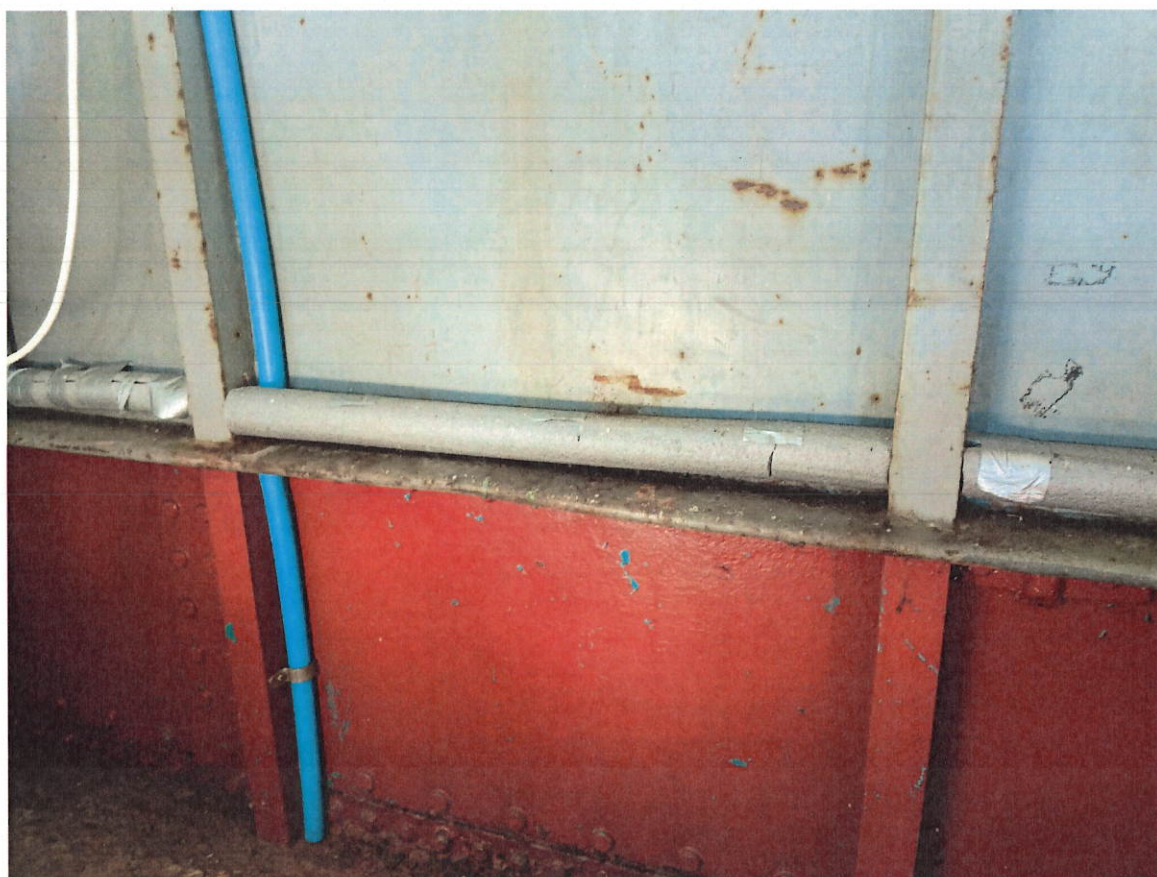
Fot. 66. Pokład dolny, nadbudówka, widoczna oryginalna, nitowana burta.
