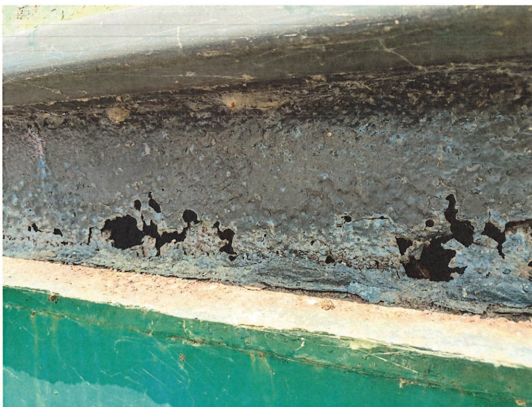
Fot. 27. Korozja wżerowa na dospawanej burcie.
