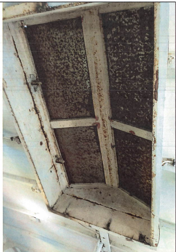
Fot. 63 i 64. Pokład dolny. Wnętrze nadbudówki z lat 60-tych i widok od spodu zaspawanego włązu z pokładu górnego.
