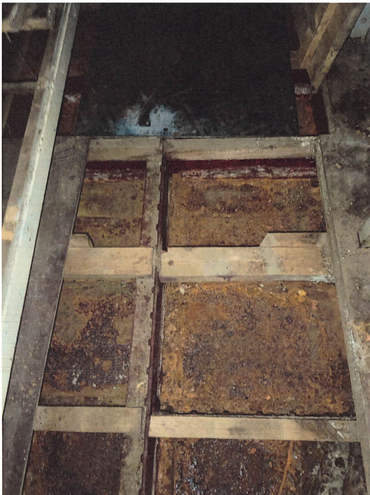
Fot. 42. Oryginalne poszycie denne kadłuba holownika.
