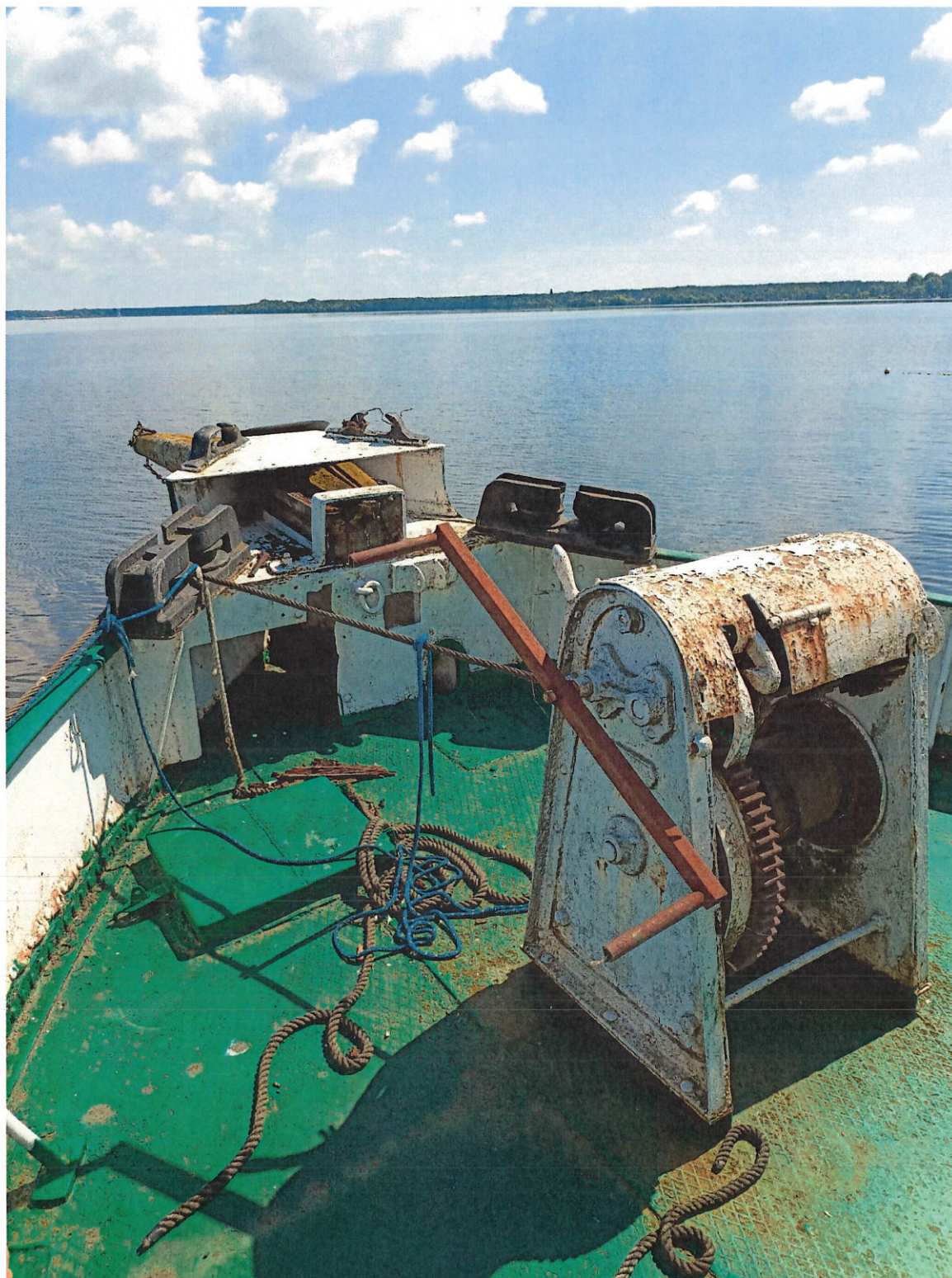
Fot. 25. Pokład dziobowy. Oryginalna wyciągarka kotwiczna.
