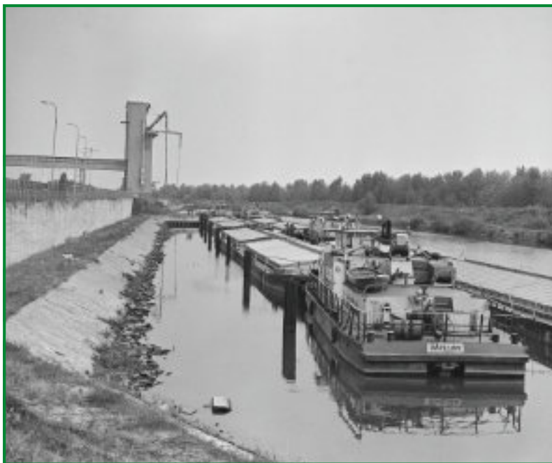
Rys. 6.9. Pchacze typu Żubr z barkami do przewozu zboża pod elewátorem zbożowym na Kanale Żerańskim, IX 1978 r. (Narodowe Archiwum Cyfrowe 3/40/0/3/368481)
