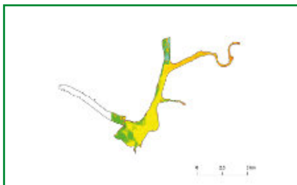
Rys. 5.12. Strumień zawiesiny wpływający z Bugu do Jeziora Zegrzyńskiego widoczny na obrazie satelitarnym Sentinel 2 z dnia 31 VIII 2017 zarejestrowany w zakresie światła zielonego (kanał B3)
